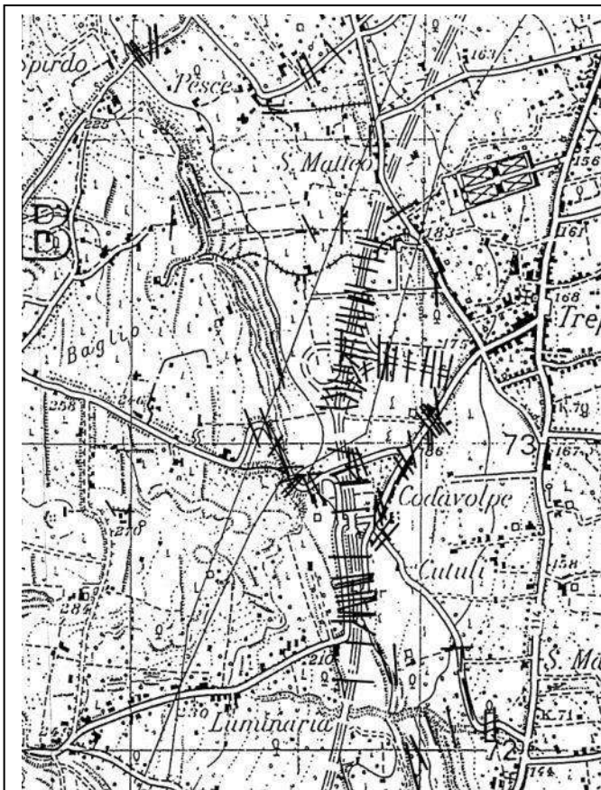
Figura 3.3.4.1.10 – Campo delle fratture cosismiche al terremoto del 29/01/1989 (in Patanè G. & Imposa S., 1995)
